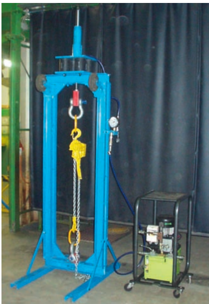
Das Modell 485 HH ermöglicht je nach Ausbaustufe statische und dynamische Zugprüfungen für Hebezeuge, Zug- und Spanngeräte.
