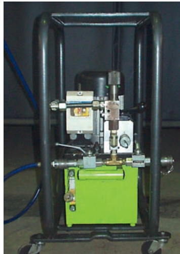
In der Ausbaustufe III sind dynamische Prüfungen möglich und die Handpumpe wird durch ein Hydraulik-Aggregat ersetzt.
